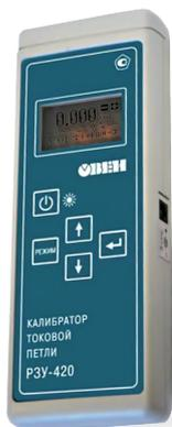
Предназначен для задания унифицированных сигналов тока  $4...20\text{ mA}$  в процессе испытания систем автоматики, а также для контроля величины тока и напряжения.
